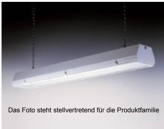
Symmetrische Arbeitsplatzleuchte als Hängeleuchte mit rückseitiger Aufhängung alternativ Schwenkleuchte mit stirnseitigen Stehbolzen in 2 Breiten. Einscheibensicherheitsglas (ESG) optional Polycarbonatscheibe in Rahmenmontiert. Die schmale Ausführung kann mit einem Blendraster nachgerüstet werden.
